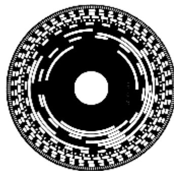
Disque de codeur absolu 12 pistes
